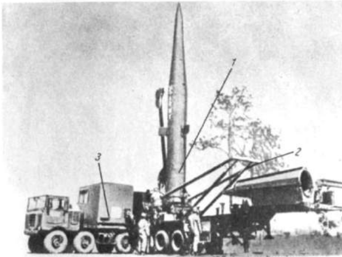
Startvorbereitung der aufgerichteten Rakete [Bild 506.30] 1 – Rakete auf dem Starttisch; 2 – Teile der Aufrichtevorrichtung; 3 – LKW mit Programmier-, Prüf- und Kraftstation
