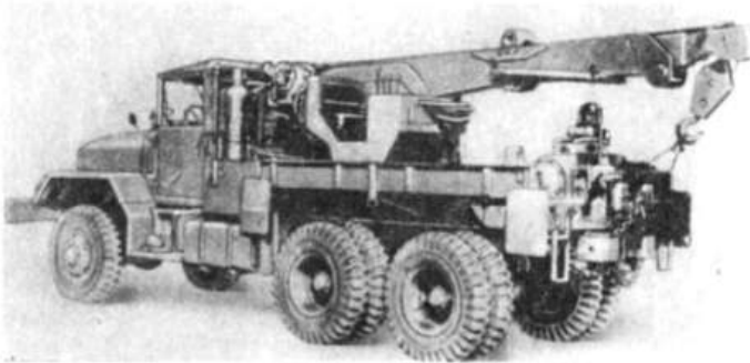
Kranfahrzeug, 5 Mp [Bild 506.7]
