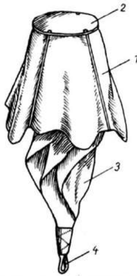
Hilfsfallschirm »Optimus« [Bild 616.7] 1 - Kappe; 2 - Federteller; 3 - Seiten- flosse; 4 - Schlaufe
