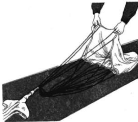
Kontrolle der Fangleinen beim Stabilisator [Bild 616.33]
