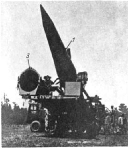
Aufrichten der montierten Rakete [Bild 506.29] 1 – montierte Rakete; 2 – Transport- und Startfahrzeug mit ab- gesenktem Starttisch; 3 – Schutzbehälter für Raketenkopf
