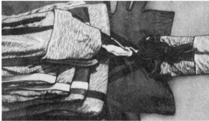
Fangleinen des Stabilisators eingeschlaucht [Bild 616.34]
