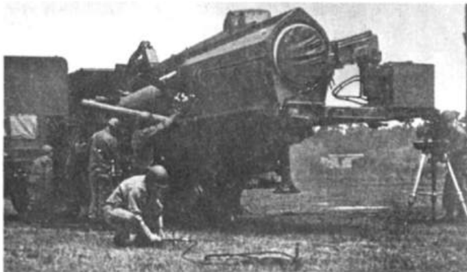
Transport- und Startfahrzeug nach dem Lösen der Sattelzugmaschine [Bild 506.28]
