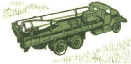
Raketentransportfahrzeug, 5 Mp (beim Transport ist die Ladefläche durch eine Plane abgedeckt) [Bild 506.5]
