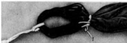
Umschlingen der Hilfsleine um die Polöffnung [Bild 616.22]
