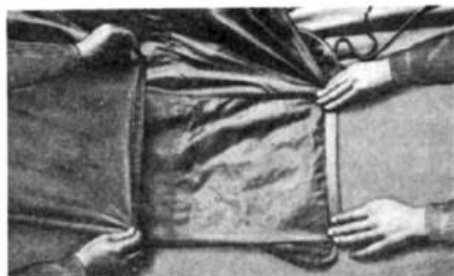
Legen der Bahn Nr. 16 und Ablegen in Richtung Basis [Bild 616.23]
