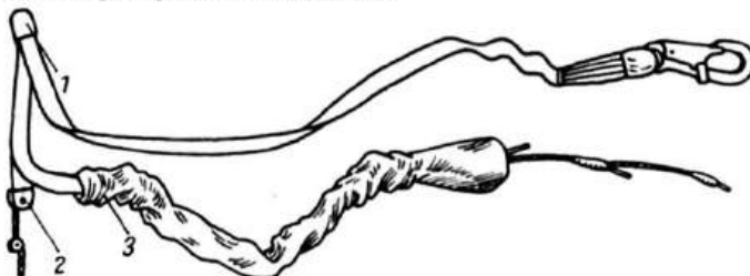
für Fallschirmsprünge mit stabilisiertem Fall über 250 km/h [Bild 616.14] 1 – Schlaufe bleibt frei; 2 – Schlaufe zur Befestigung der Automatenleine für den stabilisierten Fall; 3 – Schlaufe zur Befestigung des automatischen Aufzugsseils und der Schutzhülle
